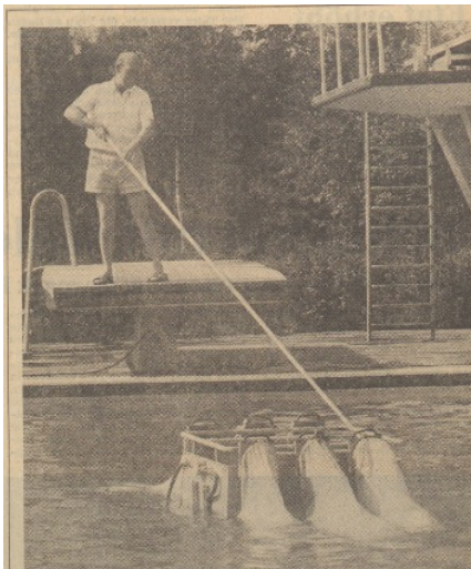
Mit einem Unterwasserstaubsauger reinigt Willi Buck das Becken
